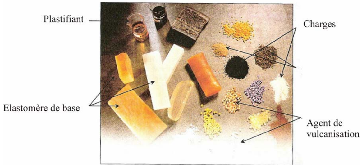
Figure 8 : Aspect des principaux constituants d'un mélange [KOS 03]
