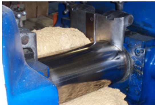
Figure 10 : Mélangeur externe [www.caoutchouc.qc.ca]
