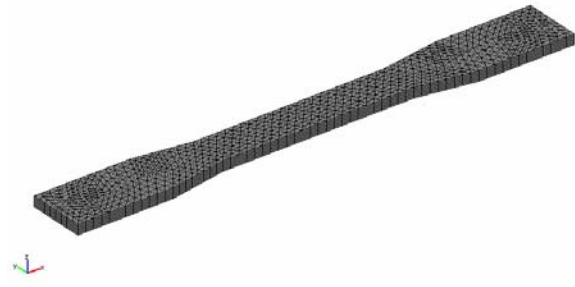
Figure 43 : Maillage de la géométrie (7872 éléments)
