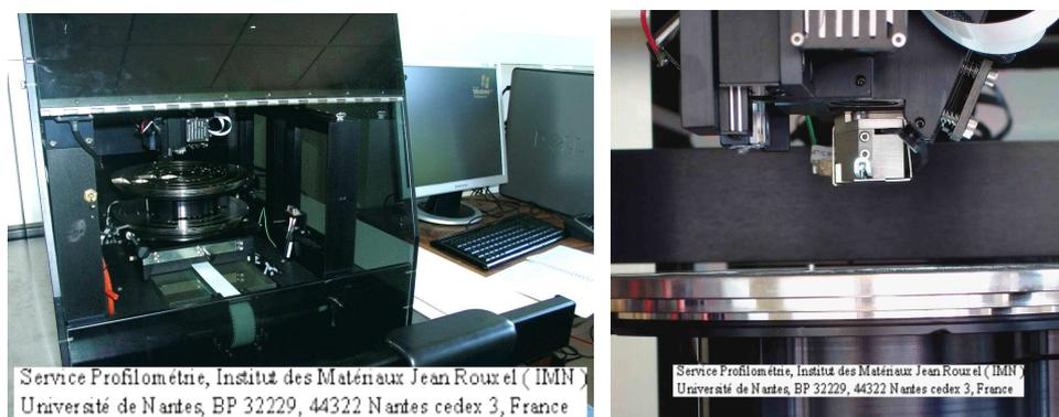
Figure 68 : Photos du profilomètre mécanique Dektak 8 (Veeco) de l'Institut des Matériaux de Nantes (IMN).
