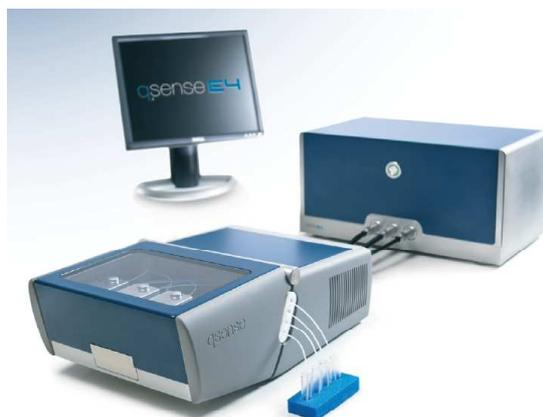
**Figure 78 : Photographie du système de QCM-D comprenant 4 cellules de mesure et de l'unité électronique interfacés à un ordinateur.**
