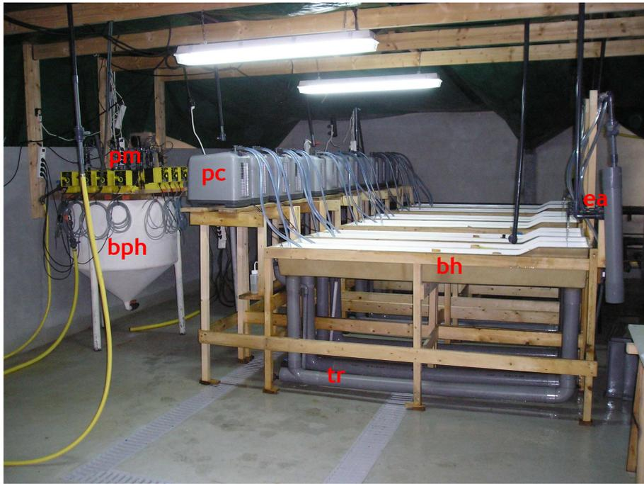
**Figure 11.** Vue générale des 12 systèmes re-circulés. *ea* : entrée d'eau dans le système re-circulé, *bh* : bac contenant les paniers d'huîtres, *pc* : pompe à chaleur assurant la thermorégulation de l'eau et équipée d'une lampe UV, *pm* : pompe à membranes apportant le phytoplancton au système re-circulé, *bph* : bac de stockage du phytoplancton *tr* : tuyau PVC assurant le retour de l'eau en début de bac.
