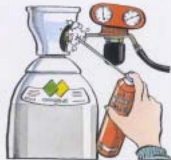
Testez l'étanchéité avec le "1 000 bulles"
