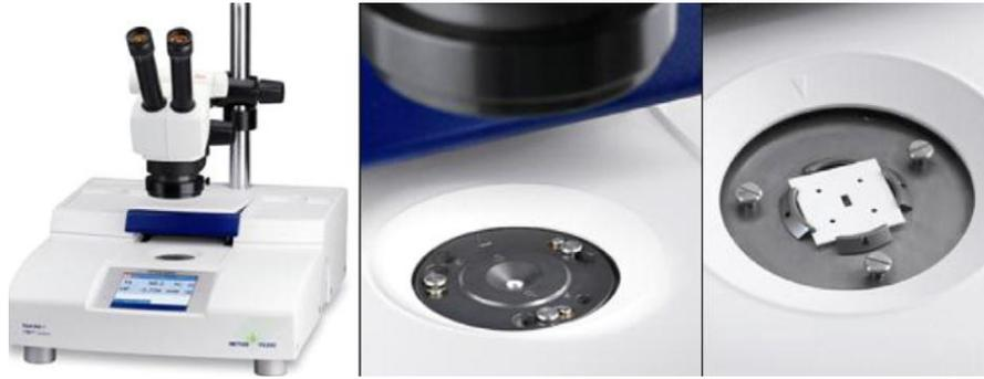
Figure II- 23 Méthode de préparation de l'échantillon de la DSC Flash
