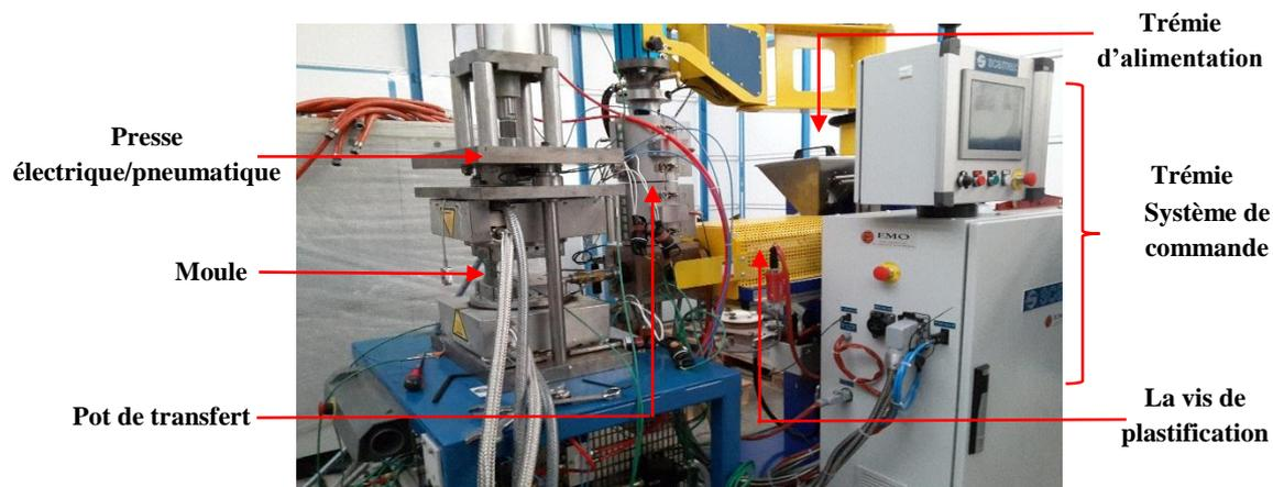
Figure III- 45 Extrudeuse et le pot de transfert connecté avec le moule
