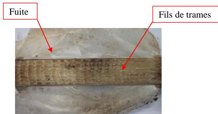
Figure IV- 6 Pièce composite du PA 66 (F) injectée à une pression de 20 bar - Déformation de la préforme fibreuse et fuite de polymère fondu
