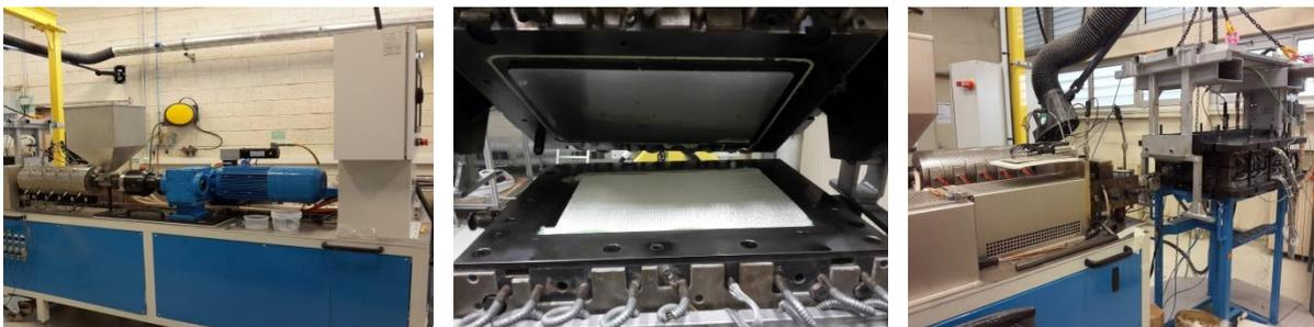
Figure III- 52 Les composants principaux du procédé RTM-TP
