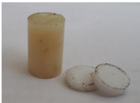
Figure III- 20 Echantillon de PA 66 préparé par le PvT-xT
