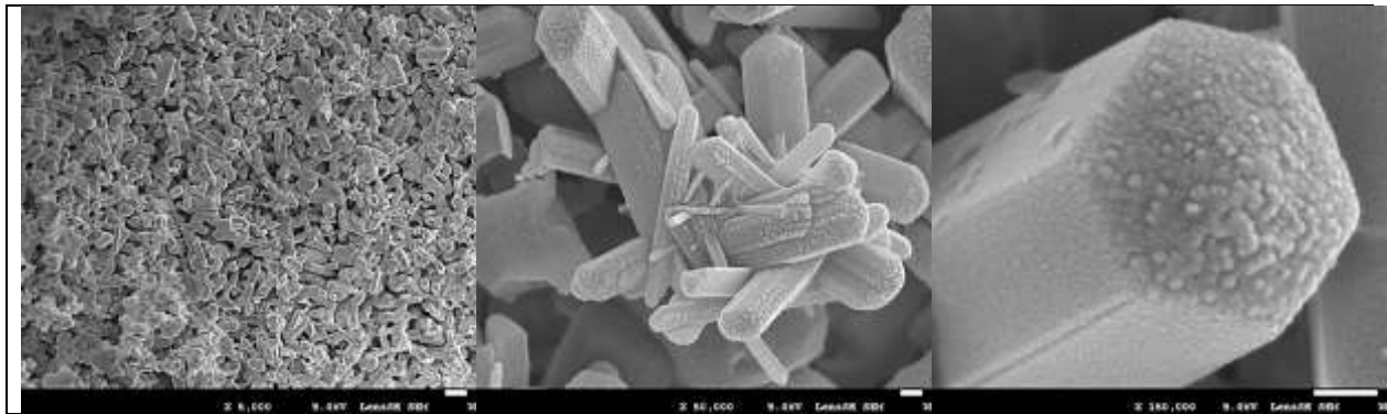
Figure 14 : Frittage incomplet d'un BCP 6040 réalisé au LIOAD
