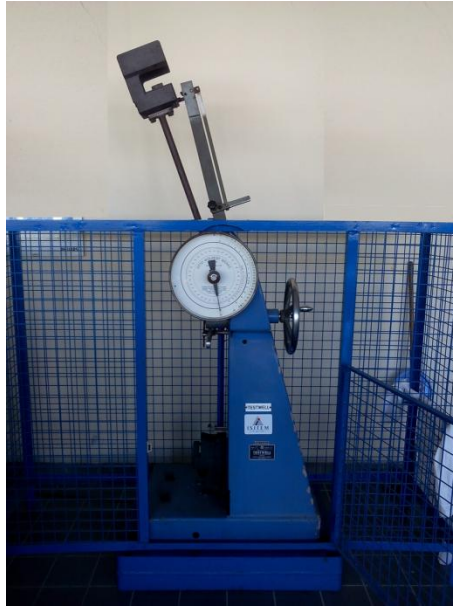
Figure II-8 : Mouton pendule Charpy utilisé pour ces essais
