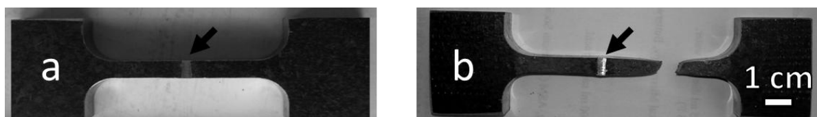
Figure IV-7 : Éprouvettes de traction du cordon hybride avant essai de traction (c), après essai de traction (d) ; la flèche noire indique l'emplacement de la ligne de fusion
