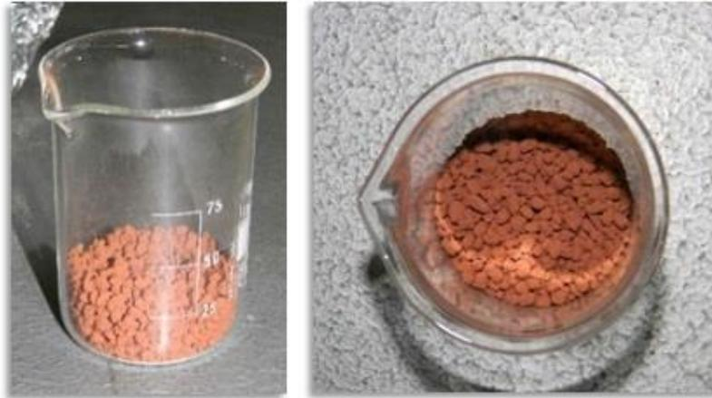
Figure 4-4 : Photographique d'un échantillon de Bauxaline®
