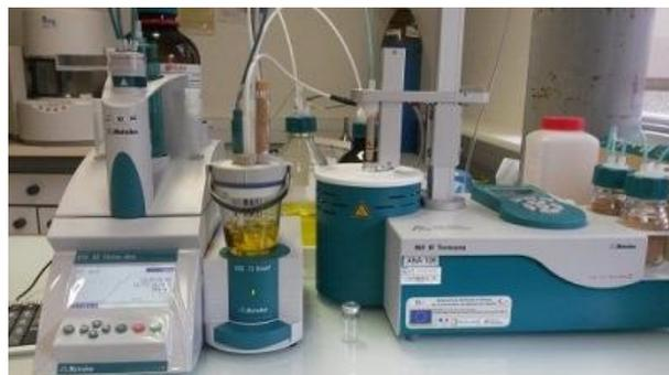
**Figure 2-29 : Appareil de mesure Karl-Fisher**
