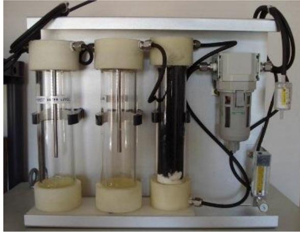
Figure 2-24 : Système de conditionnement du gaz avant analyse
