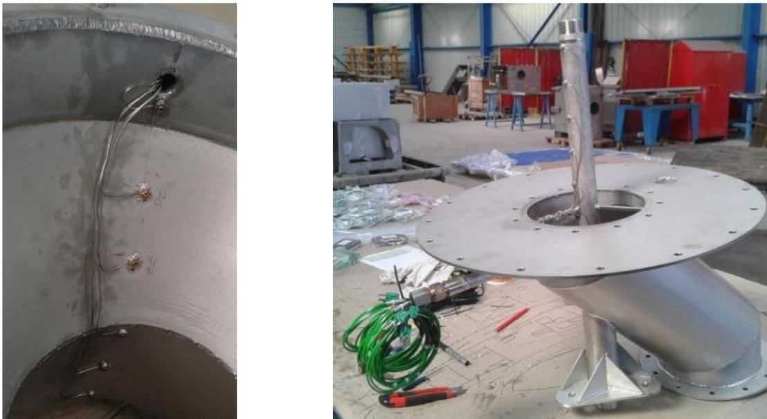
Figure 2-19 : Montage des sondes de température
