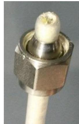
Figure 4-12 : Déposition de soufre sur le tuyau de sortie
