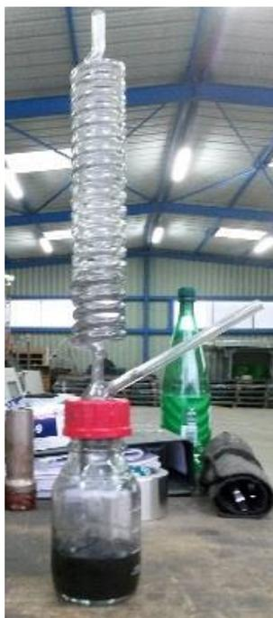
Figure 2-39 : Essai 1.2 - Condensats collectés par le serpentin
