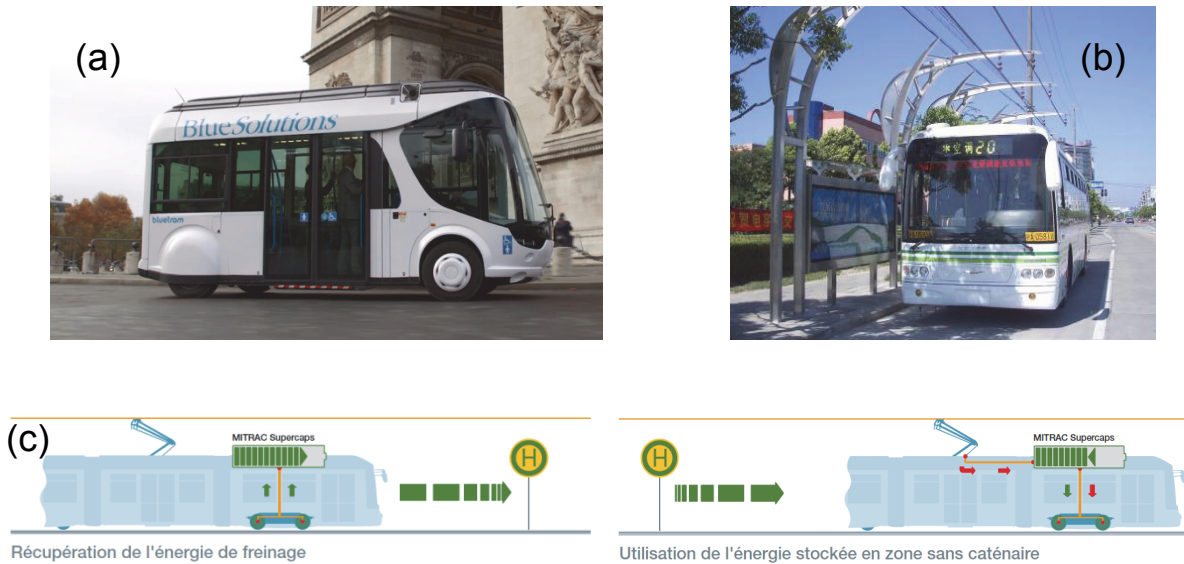
Figure I-13 : Quelques applications des supercondensateurs dans les transports en commun : (a) Bluetram de Bolloré, (b) Bus en fonctionnement à Shanghai se rechargeant en station, (c) Fonctionnement des systèmes embarqués MITRAC de Bombardier (sur les tramways)
