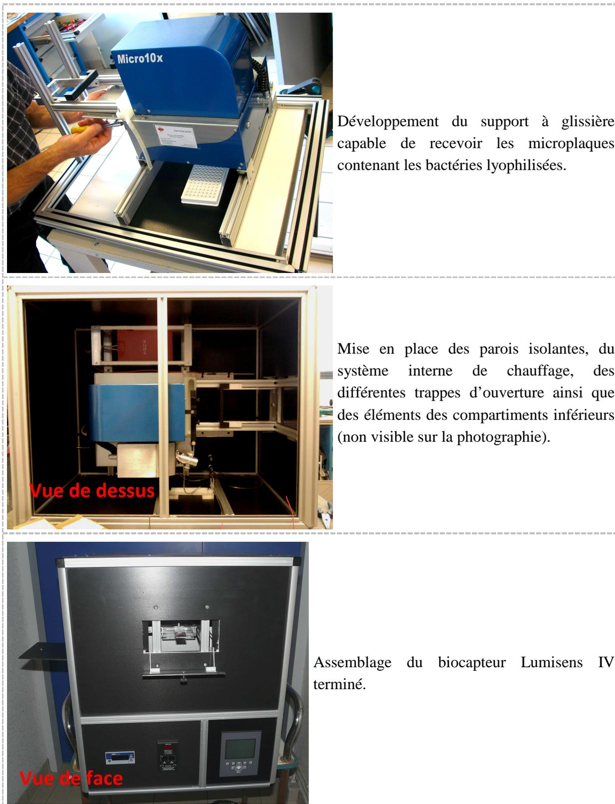
**FIGURE 59 :** PHOTOGRAPHIES DE QUELQUES ETAPES DE LA CONSTRUCTION DE LUMISENS IV.
