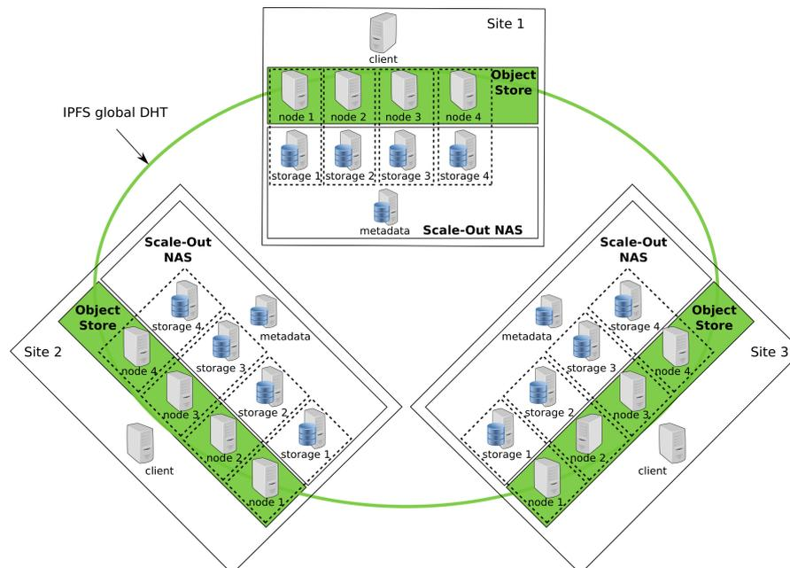
FIGURE 5.1 – Topologie utilisée pour déployer une solution de stockage en mode objet au-dessus d'un système de fichiers distribué localement sur chaque site.
