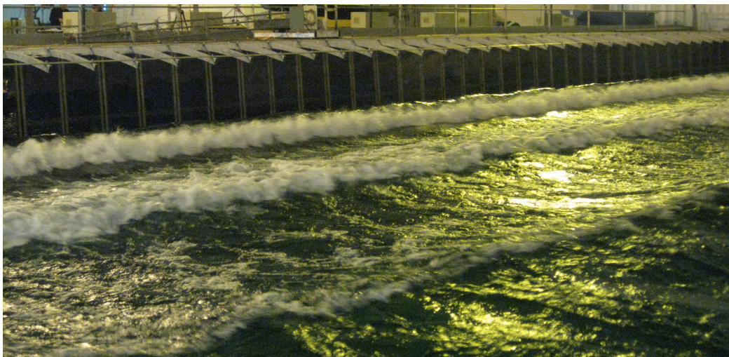
FIG. 2.7 – Photo du batteur dans le bassin de houle.
