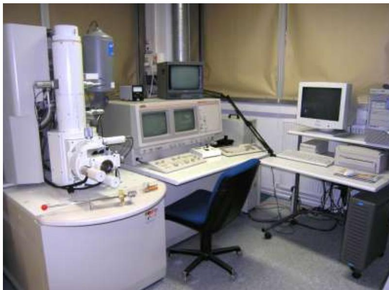
**Figure 13. Appareil de Microscopie électronique à balayage, à effet de champ Jeol JSM-6301 F destiné à l'observation d'échantillons secs, conducteurs ou faiblement isolants (Tension d'accélération: 0,5 à 30 kV /agrandissement de 10 à 450 000/Résolution 2 nm). Laboratoire SCIAM, Angers.**
