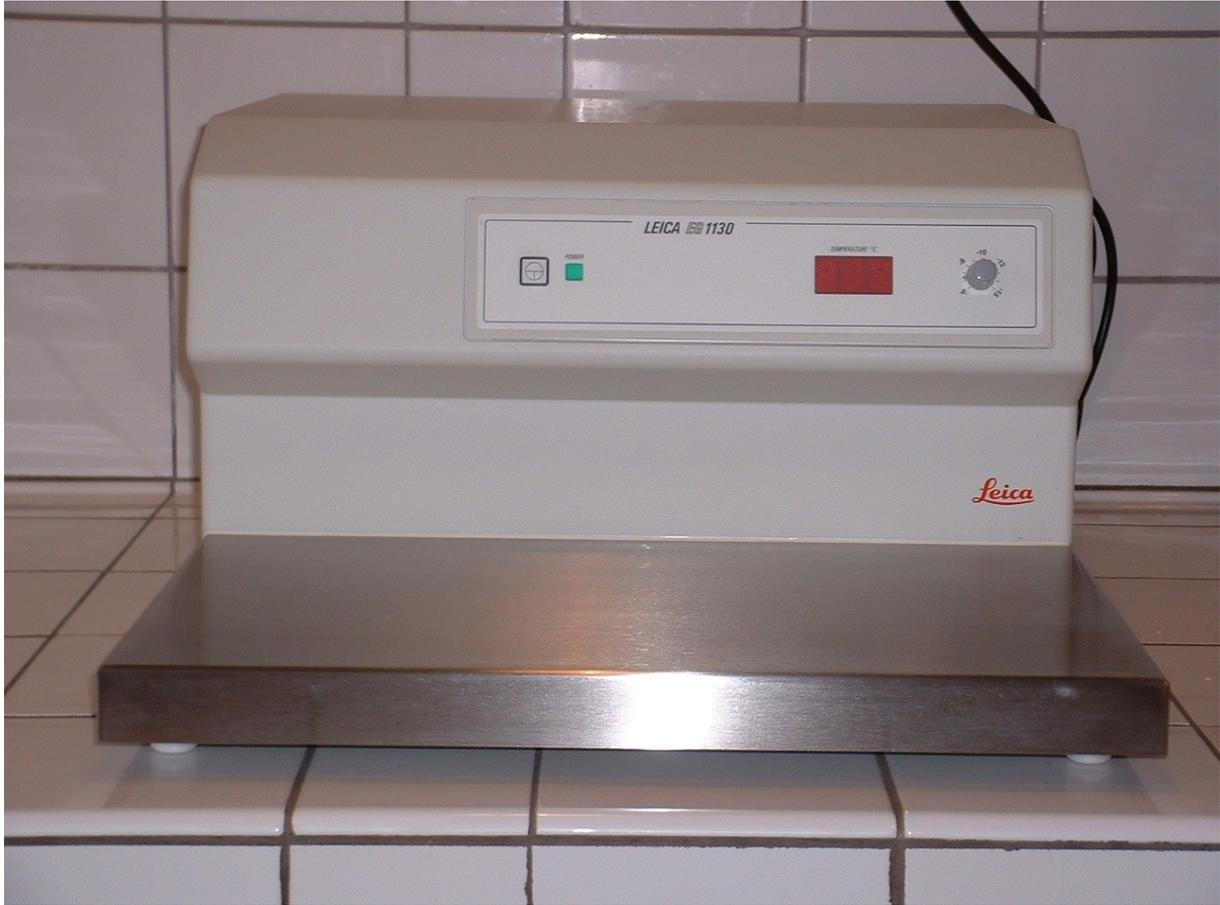
**Figure 8 : Plaque réfrigérante**
