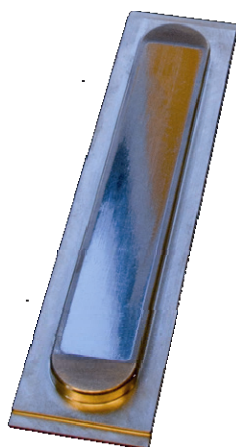
Figure 1. Cible de ^{209}\text{Bi} sur support aluminium.
