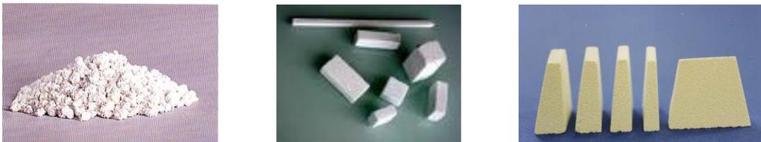
**Figure 1: Images d'implants phosphocalciques : de gauche à droite, granules de comblements, blocs usinés, coins d'ostéotomie.**
