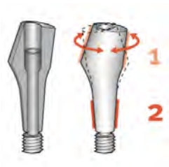
FIGURE 18: LES TETES DE PILIER EN ROTATION LIBRE (1) GRACE A LEUR CONNEXION CONIQUE (2). (83)
