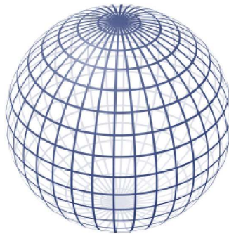
FIG. 2.3 – Représentation classique du maillage d'une sphère selon méridiens et parallèles. On remarque la particularité d'un tel maillage au niveau des pôles, la surface de chaque maille diminue depuis l'équateur jusqu'au pôle, jusqu'à ce que les rectangles de l'équateur deviennent des triangles aux pôles.
