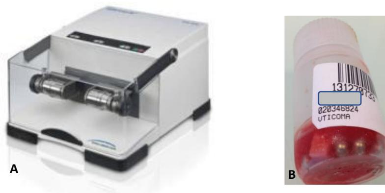
Figure 4 : Broyeur MM 400 Retsch® (A) et pot de prélèvement bactériologique avec billes métalliques (B)
