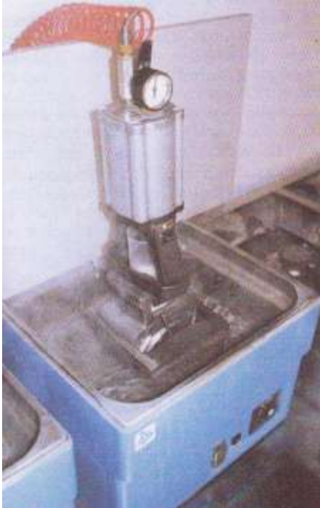
Fig.21. Presse hydraulique utilisée pour la résine injectée thermopolymérisée.
