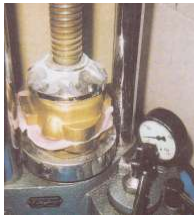
Fig.16. Echappement de la résine en excès lors de la mise sous pression progressive du moufle.
