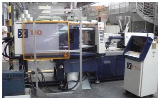
FIG. 2.1 – Presse à injecter utilisée
