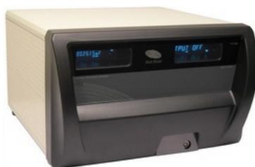
FIG. 2.19 – Le conductivimètre HotDisk (TPS 2500)
