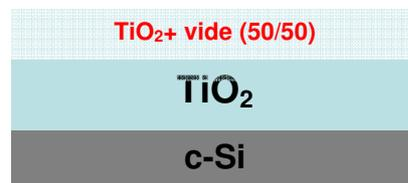
(b) Modèle II : 2 couches de  $\text{TiO}_2$
