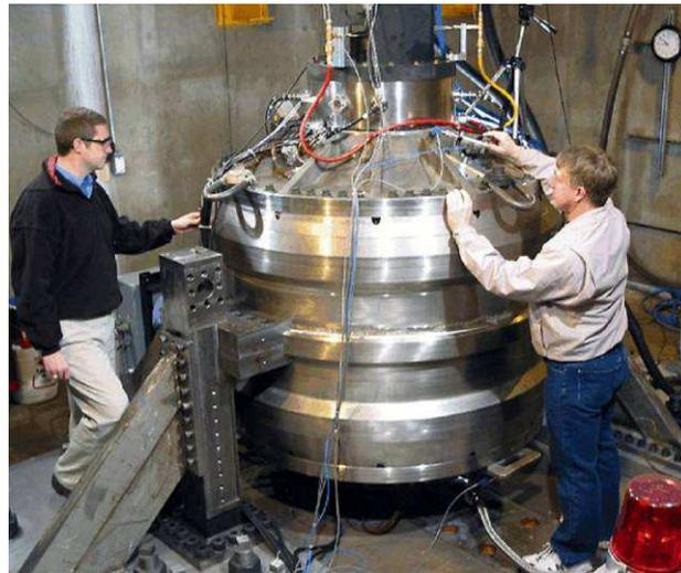
Figure I-12 - Système de stockage inertiel de 2 MW - 100 kWh [Thelen-03]
