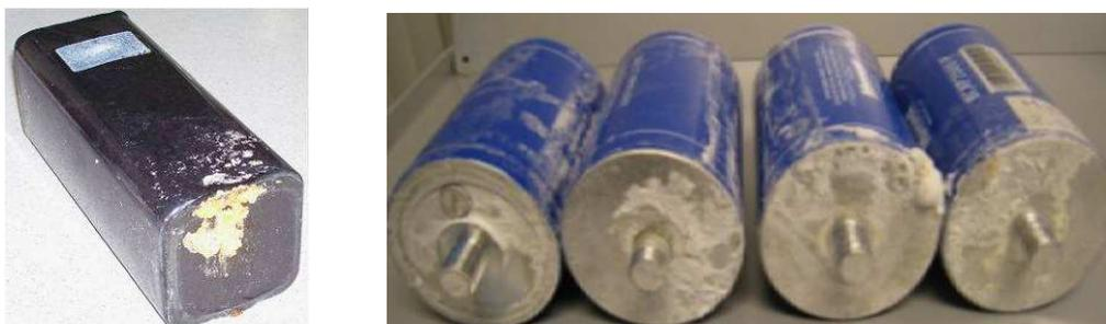
Figure II-18 - Fuite d'électrolyte suite à une faiblesse du boîtier de la cellule [Kurzweil-08, Chaari-11b]
