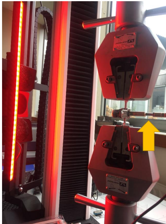
FIGURE V-8. PHOTOGRAPHIE DU DISPOSITIF EXPÉRIMENTAL LORS DE LA RÉALISATION DES ESSAIS DE TRACTION COUPLÉS AUX MESURES AU FERITSCOPE
