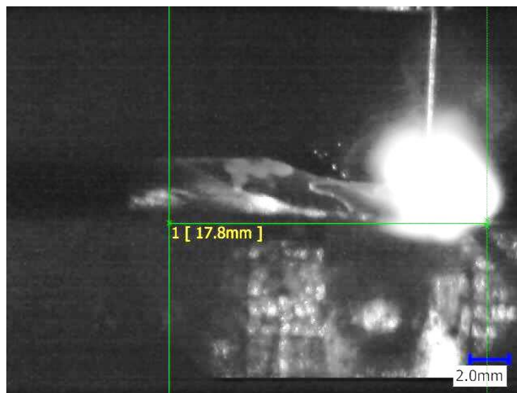
FIGURE III-14. IMAGE ISSUE DE LA CAMÉRA HAUTE VITESSE LORS DU DÉPÔT DE LA PREMIÈRE PASSE
