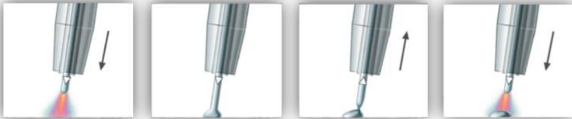
FIGURE II-18. PRINCIPE DU COLD METAL TRANSFER (CMT®) (D'APRÈS DOCUMENTATION FRONIUS®)
