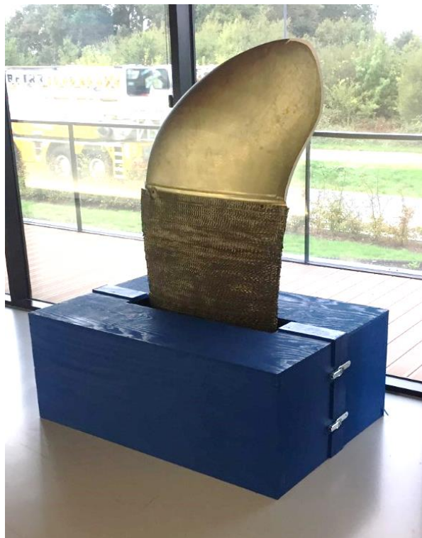
FIGURE 0-1. PALE D'HÉLICE PRODUITE PAR FABRICATION ADDITIVE ARC-FIL PAR NAVAL GROUP - ECN
