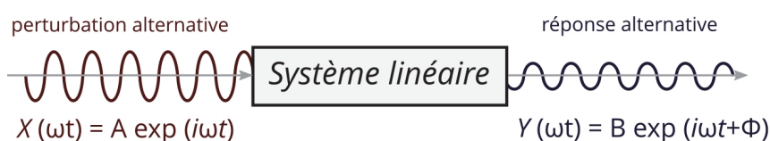
Figure 2.13 – principe de la mesure de spectroscopie d'impédance
