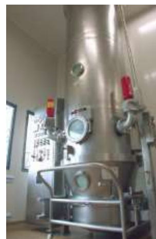
Figure 34 : Séchoir à lit d'air fluidisé
