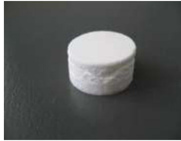
Figure 26 : Clivage d'un compact de lactose après éjection [31]
