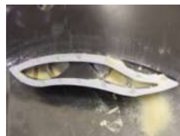
Figure 47 : Déchaussement du joint du distributeur
