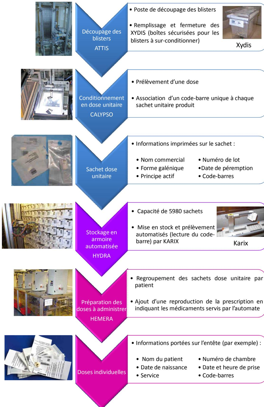
Figure 14 : Fonctionnement de l'automate Athena de Sinteco (d'après [40])
