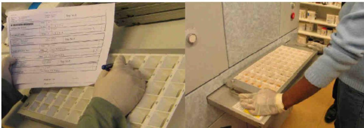
Figure 10 : Plateau d'alimentation semi-automatique de l'automate Sygiph
