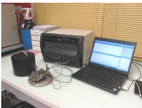
Figure II-26 – Système Hot Disk TPS 2500
