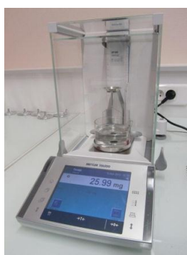
Figure II-29 - Balance METTLER TOLEDO équipée du montage «masse volumique»
