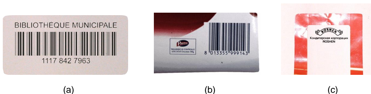
Figure II-9 – Exemples d'impression par transfert thermique : sur papier vélin 100 \mu\text{m} (a), film aluminium couché synthétique 70 \mu\text{m} (b), film polyéthylène téréphtalate 30 \mu\text{m} (c)
