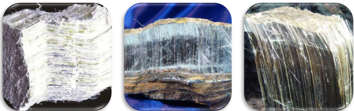
Figure 2. Principaux types de fibres d'amiante (Chrysotiles ou amiante blanc à gauche; Crocidolites ou amiante bleu au milieu; amosite à droite).
