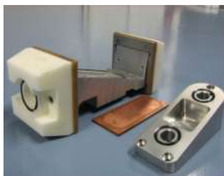
Figure 14. Cible permettant la production de ^{64}\text{Cu} à ARRONAX (au centre), accompagnée de son dispositif de refroidissement et de transport pneumatique (navette).
