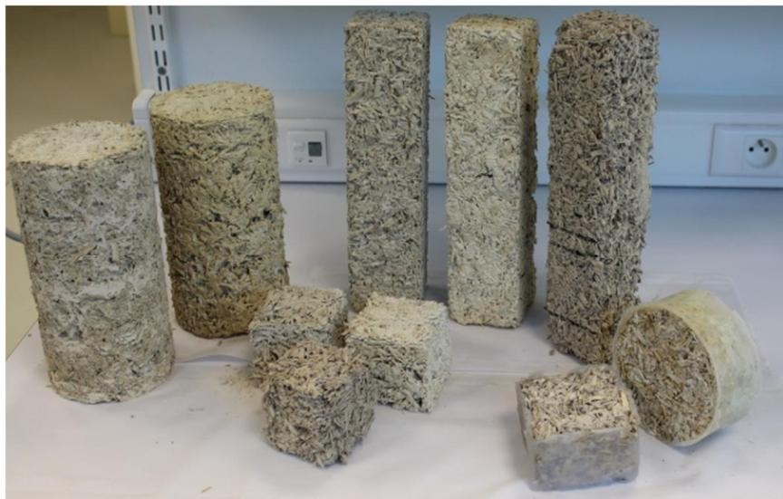
Figure III. 16: Eprouvettes utilisées pour les essais de caractérisation des bétons de chanvre
