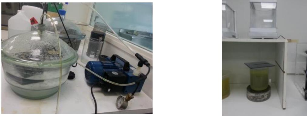
Figure II. 4 : Procédure (a) et dispositif de saturation et pesée hydrostatique (b) pour la détermination de la porosité accessible à l'eau
