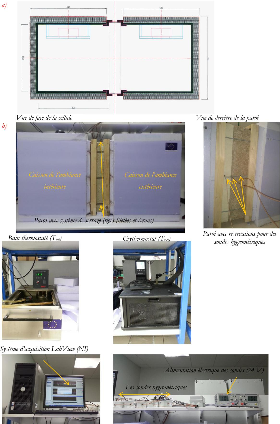
Figure IV. 1: Cellule biclimatique a) plans Auto CAD b) vue in-situ
