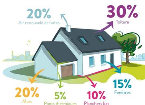
Figure I. 3 : Distribution des pertes de chaleur dans une maison non isolée<sup>7</sup>
