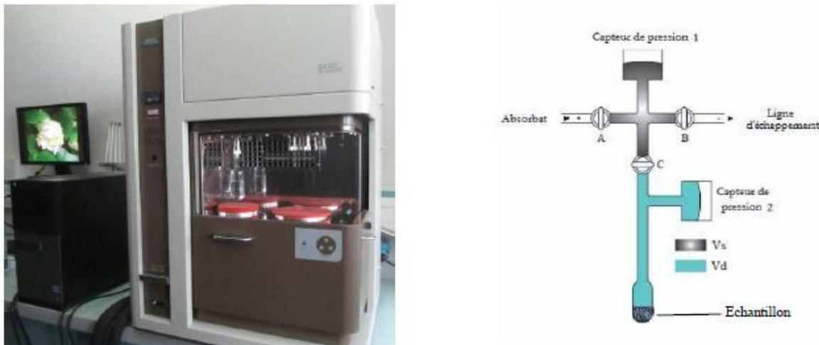
Figure II. 10 : Belsorp aqua 3 : photo (à gauche) et principe de fonctionnement (à droite)
