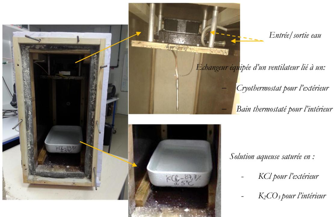
Figure IV. 2 : Photo du principe de génération de température et d'humidité relative
