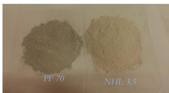
Figure III. 12 : Aspect visuel des chaux utilisées pour la confection des bétons moulés
