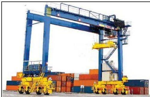
**Figure I.6 – Grue portuaire japonaise équipée de supercondensateurs**
