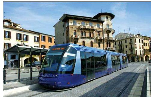
**Figure I.7 – Tramway équipé de supercondensateurs**
