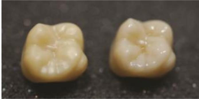
Figure 38: A gauche, couronne en zircon polie. A droite, couronne identique recouverte de glasure fluorescente ceraMotion®Zr. Photo prise à la lumière du jour. (122)
