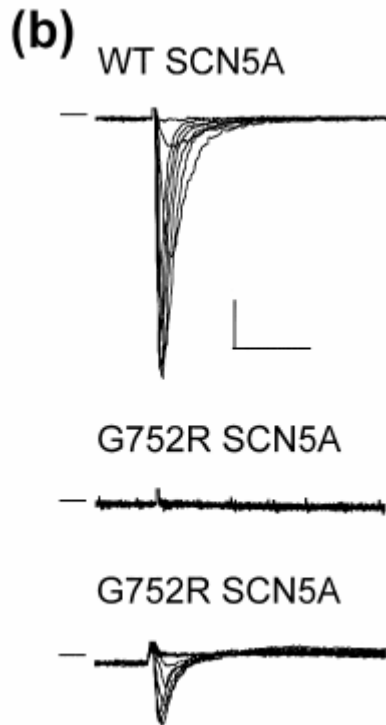
Figure 48 : Caractéristiques fonctionnelles de la protéine mutée. Les cellules étaient transfectées avec 20% de formes sauvages ou mutées de pCI-SCN5A et 80% de pTR-GFP. Le tracé inférieur était enregistré avec une concentration de 75% de pCI-SCN5A et une concentration plus faible de Na + intra-cellulaire (1 mM).
