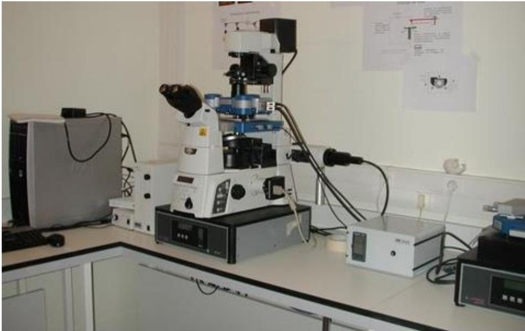
*Figure 1.16 : Photographie du Nanowizard II monté sur un microscope à épifluorescence.*
