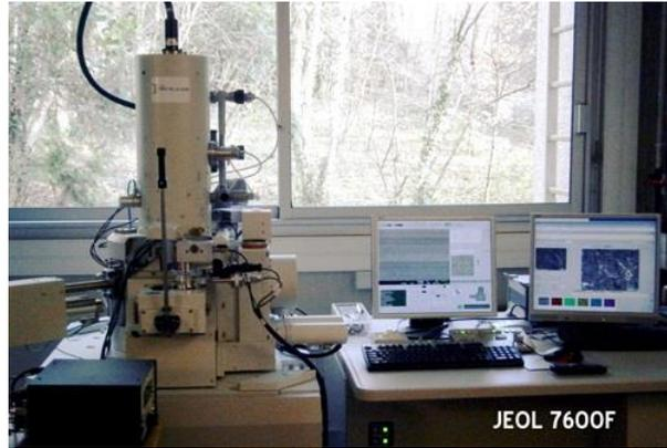
Figure 1.21 : Microscope électronique à balayage JEOL JSM 7600F de l'IMN.
