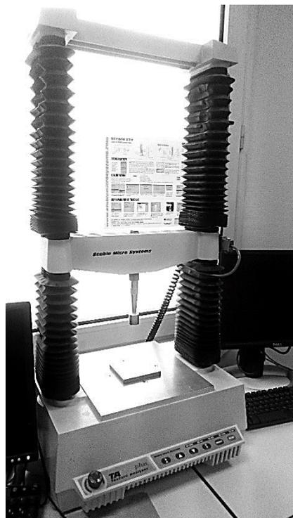
Figure 33 : Analyseur de texture permettant de faire les tests de traction
