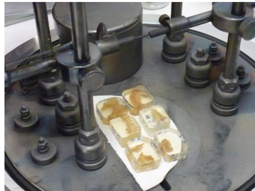
Figure 61 : Mise en place des échantillons sous la mine carbone pour la métallisation
