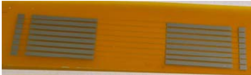
Figure III-4 : Nouveau fluxmètre avec motif électrique en cuivre étamé
