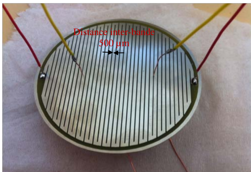
Figure IV-3: Elément chauffant du capteur
