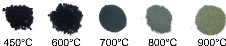
Figure 6 : Evolution de la coloration des poudres de Ni(OH)<sub>2</sub>-poudre(T) après recuit de Ni(OCH<sub>3</sub>)<sub>2</sub>·4H<sub>2</sub>O à différentes températures (450°C, 600°C, 700°C, 800°C et 900°C).
