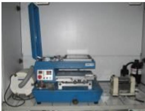
Figure 2 : Photographie de la sérigraphieuse utilisée.
