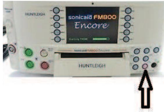
**Figure** Position du bouton rose de réinitialisation du tocomètre Sonicaid FM800 Encore® de chez Huntleigh utilisé en salle de naissance de l'Hôpital Mère-Enfant de Nantes.
