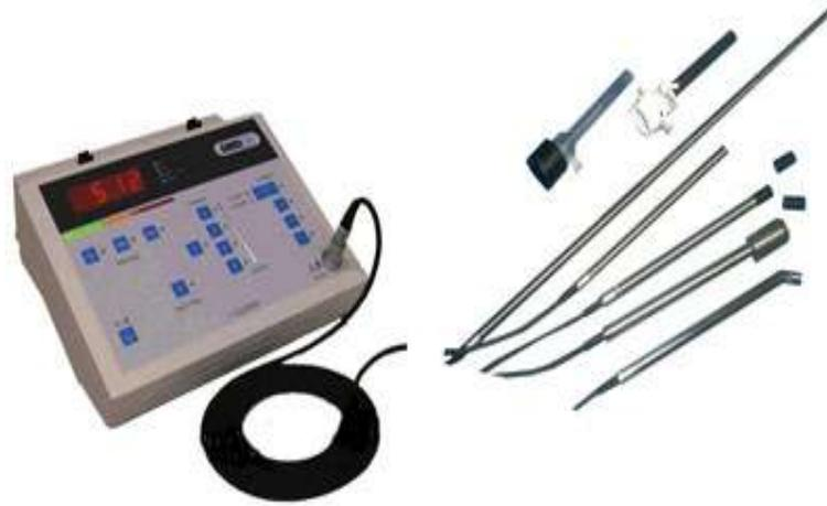
Figure 18 : A gauche, module électronique qui regroupe l'alimentation, les circuits de traitement et d'analyse des signaux, avec afficheur digital du taux de comptage. A droite, différentes sondes gamma adaptables (Clerad<sup>®</sup> - Gammasup).
