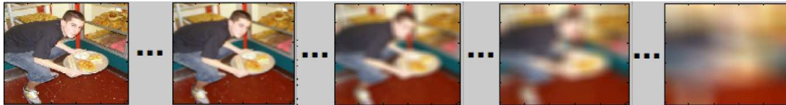
FIGURE 4.6 – Filtres passe-bas appliqués successivement à une image. De gauche à droite, l'image originale, puis les images filtrées. (Tiré de (Mancas and Le Meur, 2013).)
