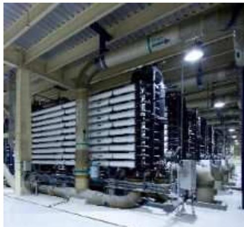
Figure 19 : Modules SEAGUARD installés à Palm Jumeirah (Knops et Horvath, 2009)
