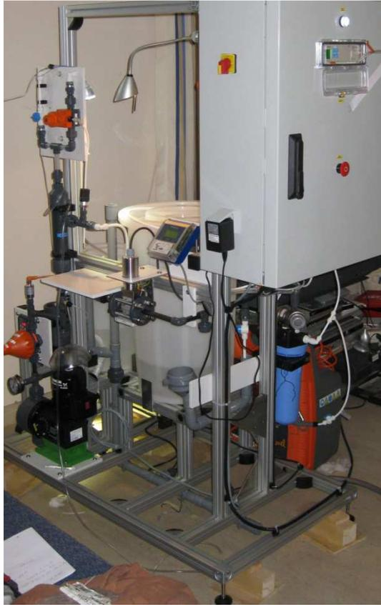
Figure 36 : Photo de l'unité de filtration frontale à flux de perméat constant
