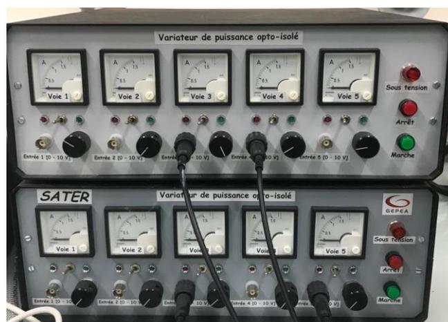
**Figure IV-21:** Variateur de puissance opto-isolé.
