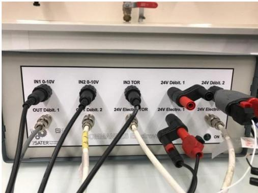
**Figure IV-25:** Boîtier de contrôle des débitmètres et des électrovannes.
