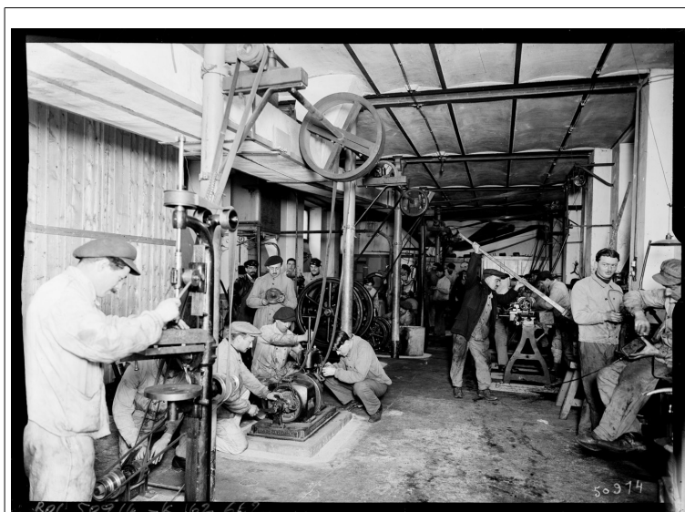
Illustration 91 : Distribution de la force motrice par courroie - 1918
