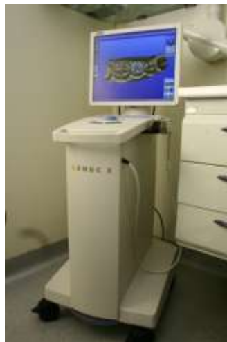
Figure 6: Le système CEREC 3 (Unité de capture et de conception) (2000)
