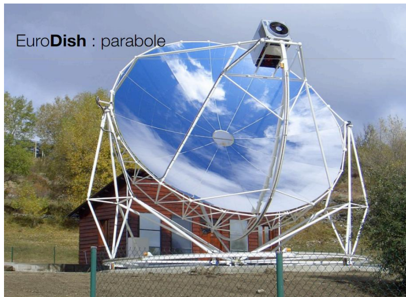
Figure 1.9. La parabole Stirling solaire du projet EuroDish (Nepveu et al., 2006)
