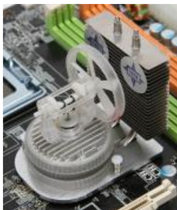
Figure 1.13. Microprocesseur refroidit par un moteur Stirling
