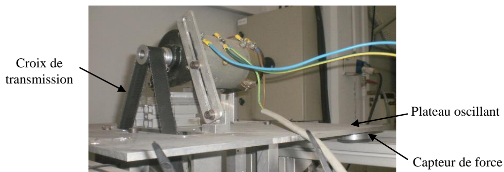
Figure 3.6. Photo de l'installation du capteur de force
