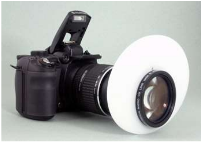
Figure n°45 : APN équipée d'un diffuseur de lumière posé sur l'objectif (d'après PTJ International) (63)
