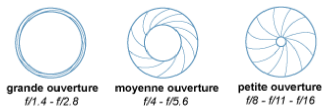
Figure n°33 : les types d'ouverture du diaphragme (d'après absolutphoto.com) (1)
