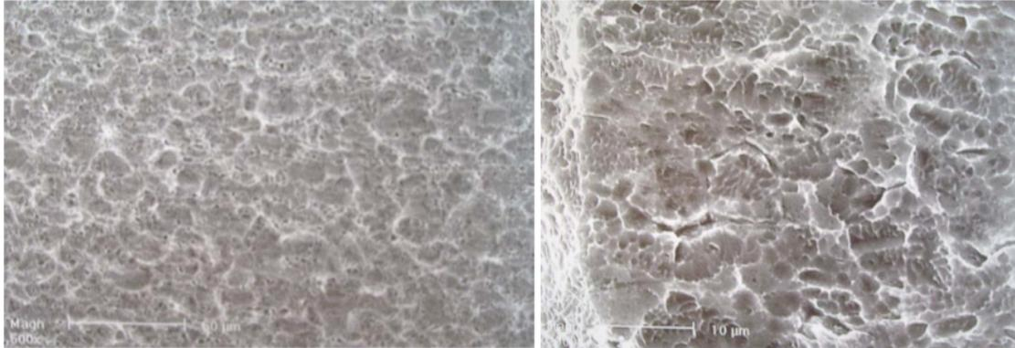
Figure 5 : Image de la surface obtenue par mordantage à l'acide à faible grossissement (x500) et à fort grossissement (x2000) prise au microscope électronique à balayage.
