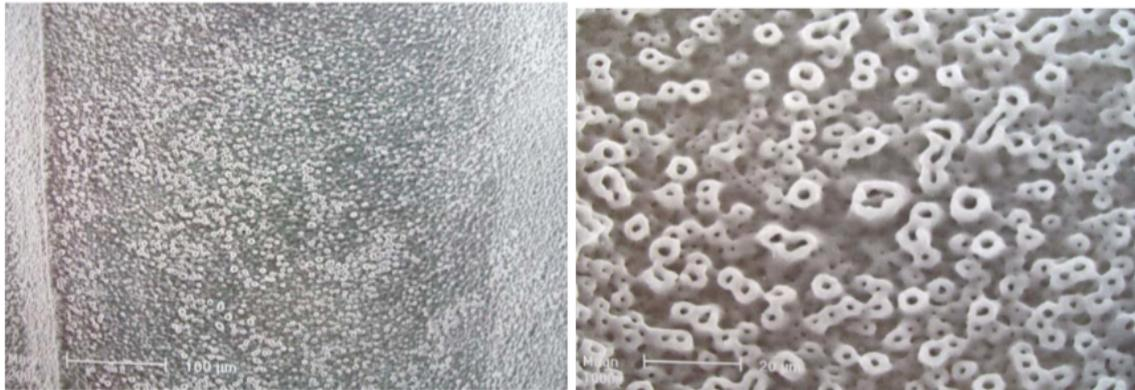
Figure 3 : Image de la surface obtenue par oxydation anodique à faible grossissement (x200) et à fort grossissement (x2000) prise au microscope électronique à balayage.
