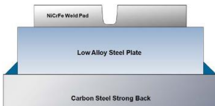
Figure 2.7 : Schéma de la maquette de soudage utilisée par l'EPRI (20).
