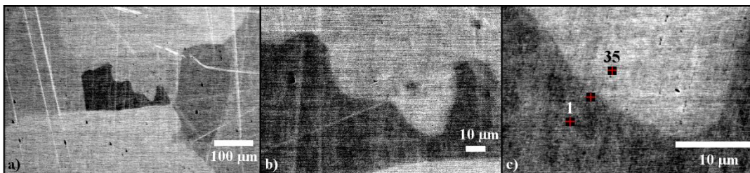
Figure 5.16. Exemple d'un joint de grains dans l'échantillon témoin de nickel à 5,4 ppm de soufre, à trois grossissements. Sur l'encadré c), il est possible de voir les premier et dernier points de la ligne d'analyse, ainsi que le point du milieu.
